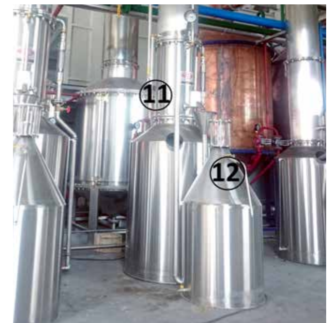
11. Охлаждащата вода се отваря, за да кондензира парата.
