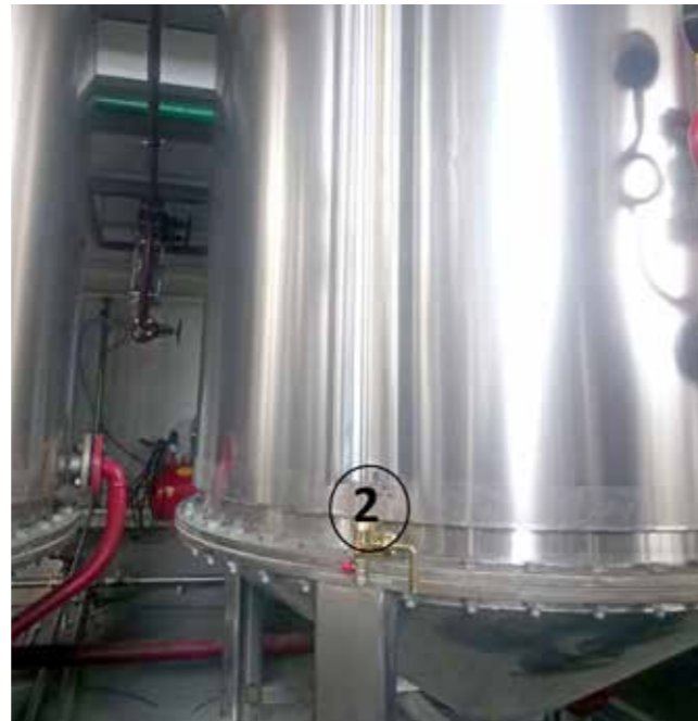
2. Проверява се дали в устройството е напълнено достатъчно вода.
