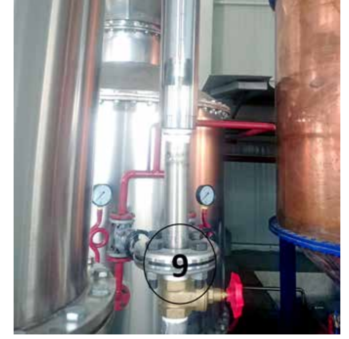
9. Kohobasyon ünitesine yağlı gül suyunu vermek için kullanılır.
