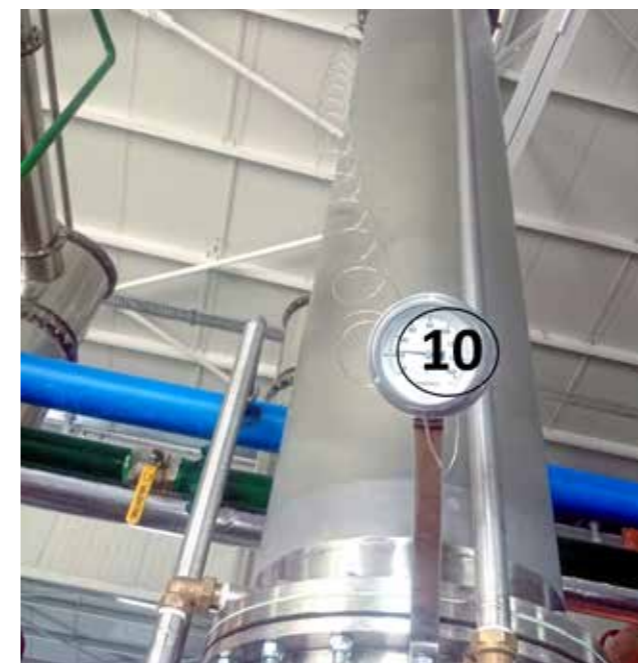
10. Види се температурата на изхода на водните пари в дестилационната единица.
