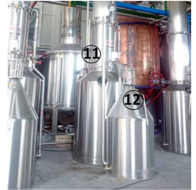
11. Soğutma suyu açılarak buharın yoğunlaşması sağlanır. 12. Cam göstergede biriken gül yağı vanadan alınır.
