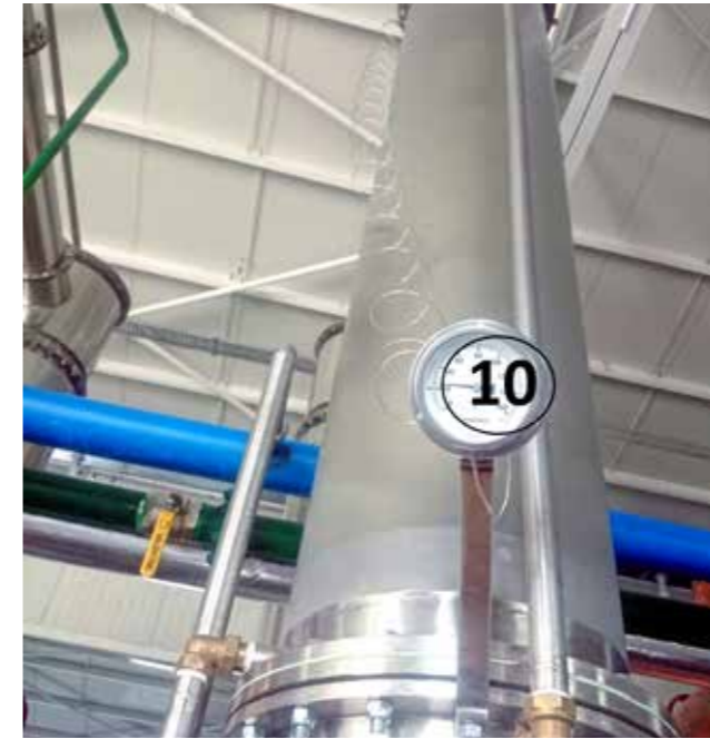
10. Distilasyon ünitesi içerisindeki su buharının çıkış ısı görülmür.
