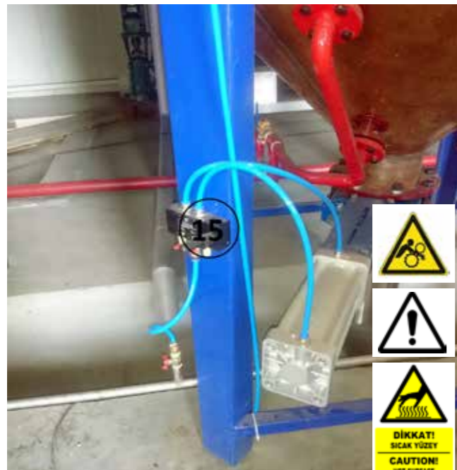
15. Когато процесът на дестилация приключи, той се използва за обезвреждане на пулпа в уреда. Използвайте след проверка на вратата 2.
